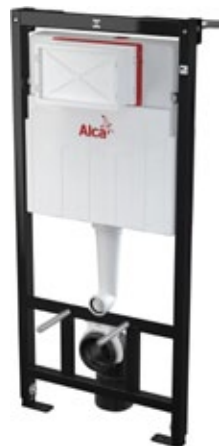
5 Sadromodul predstenový inštalovaný systém do sadrokartónu, 1120x510x160 mm BDQ1A2B 257,94 €
